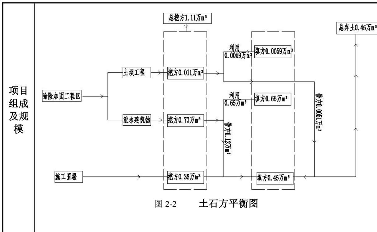
图 2-2 土石方平衡图
