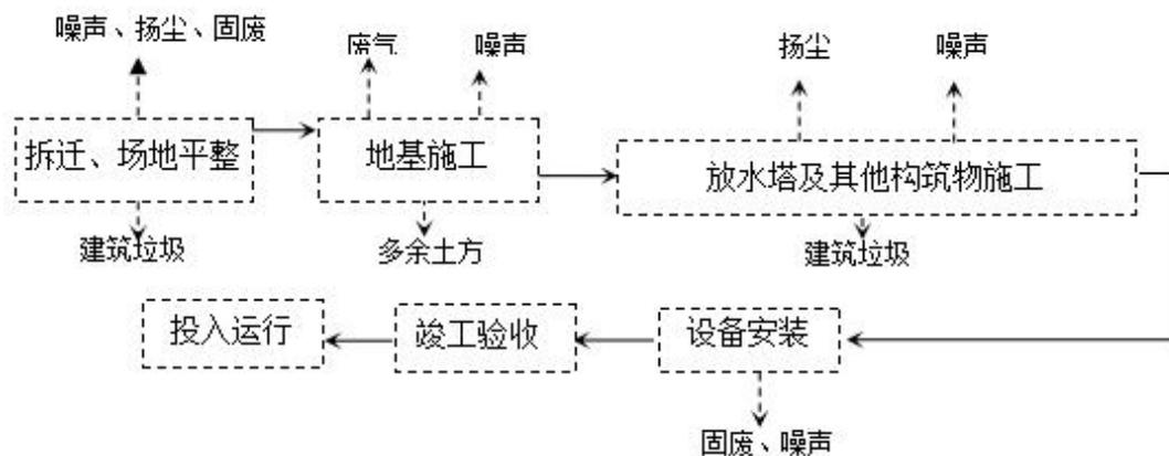
图 3.3-1 水库加固改造工程建设流程及产污环节示意图
